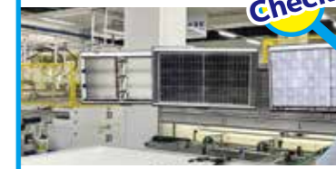
外観とELの2回目検査を行います。
