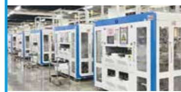
セルに配線材を溶着し、自動で直列配線して「ストリング」を作成します。
