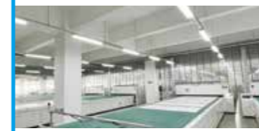
積層した部材を真空中で加熱、圧着封止します。
