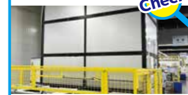
所定の出力を確認する為、暗室内で出力測定を行います。
