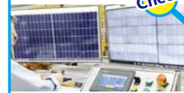
EL検査にてコンポーネント内の潜在欠陥を検出します
